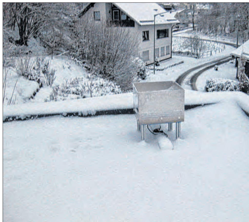
Das Wiegemodul steht auf den Dächern und misst so die Last, die vom Schnee auf die Dachkonstruktion wirkt. Wenn's gefährlich wird und Einsturzgefahr droht, gibt's Alarm.
