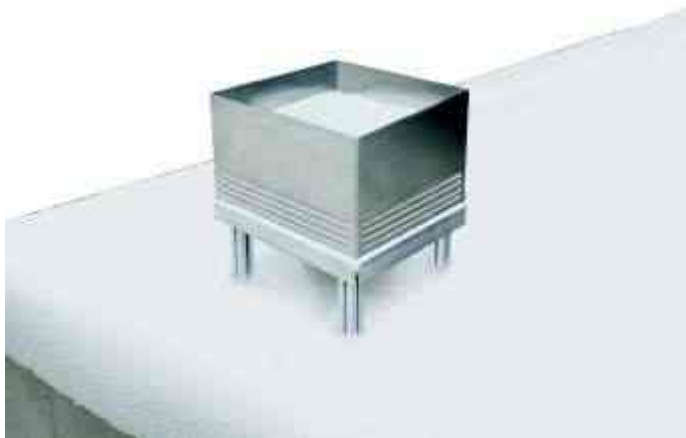
Aufbau der Schneelast-Messeinrichtung auf dem Flachdach einer Industriehalle
